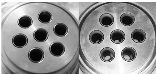
图 14 热试车前后喷注器面板照片
